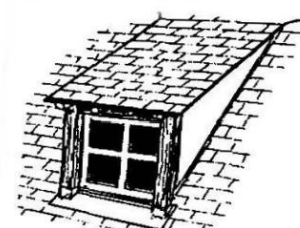
lucarne rampante ou en "chien couché"
